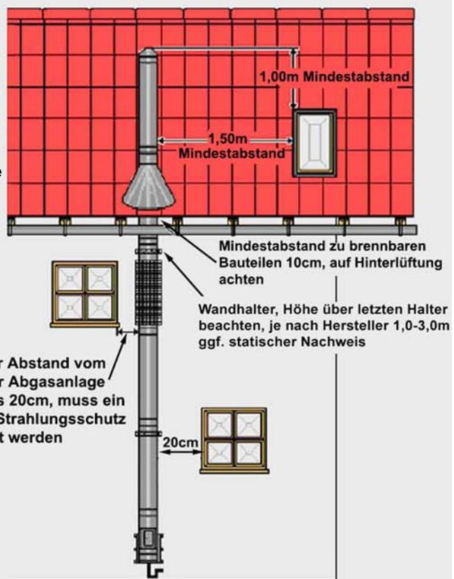
Beträgt der Abstand vom Fenster zur Abgasanlage weniger als 20cm, muss ein belüfteter Strahlungsschutz angebracht werden
